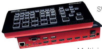
SWITCHER DE VIDEO, 4 entradas HDMI, 1 entrada DP, una salida HDMI para PGM, 1 Salida HDMI para Multiview, 1 puerto USB C para streaming, 1 puerto RJ45 para control por IP, 1 entrada miniplug para audio, 2 entradas en miniplug para micrófonos, 1 salida de audio en línea en miniplug, 1 puerto USB para antena RF de luces Tally. Incluye pack de 4 Tallys.
